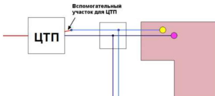
Рисунок 15 - Подключение трубопровода ГВС
