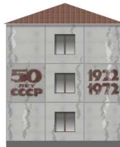
ПЛОХО. Исторические декоративные элементы фасада находятся в плохом состоянии, нуждаются в сохранении и реставрации
