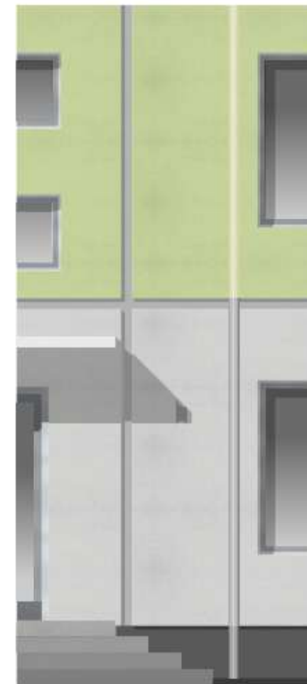
ХОРОШО. Водосточная труба соединена с ливневой канализацией
