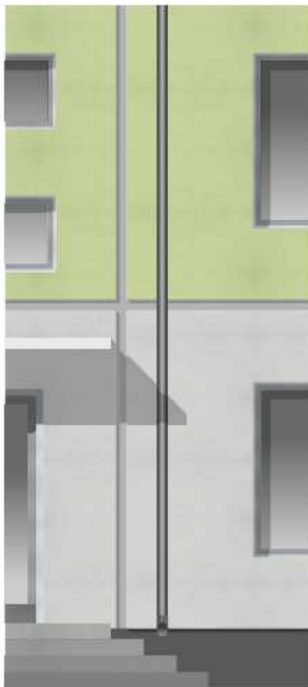
ПЛОХО. Водосточная труба выходит на лестничную площадку
