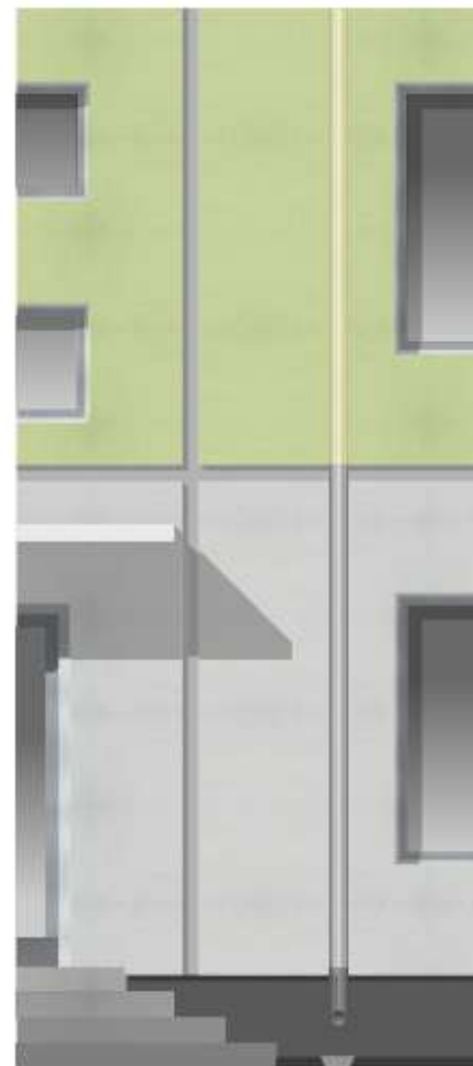
ХОРОШО. Водосточная труба имеет отвод в водопримемный лоток
