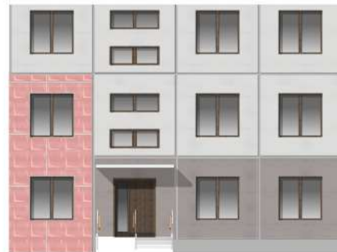
ПЛОХО. Фасад имеет фрагментарную отделку разными материалами
