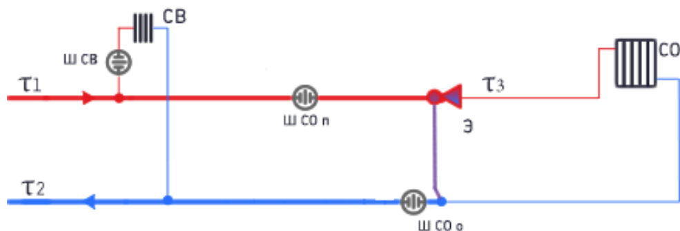
Рисунок 4 – Схема подключения потребителей к двухтрубной тепловой сети (при наличии внутридомовой системы отопления), в качестве регулятора температуры используется элеватор (СО – система отопления, Э – элеватор, СВ – система вентиляции)
