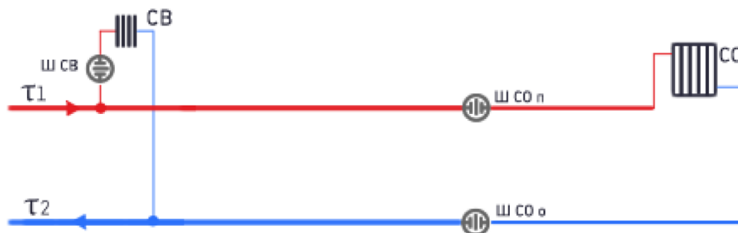
Рисунок 3 - Схема подключения потребителей к двухтрубной тепловой сети (при наличии внутридомовой системы отопления), зависимое присоединение, без смешения
