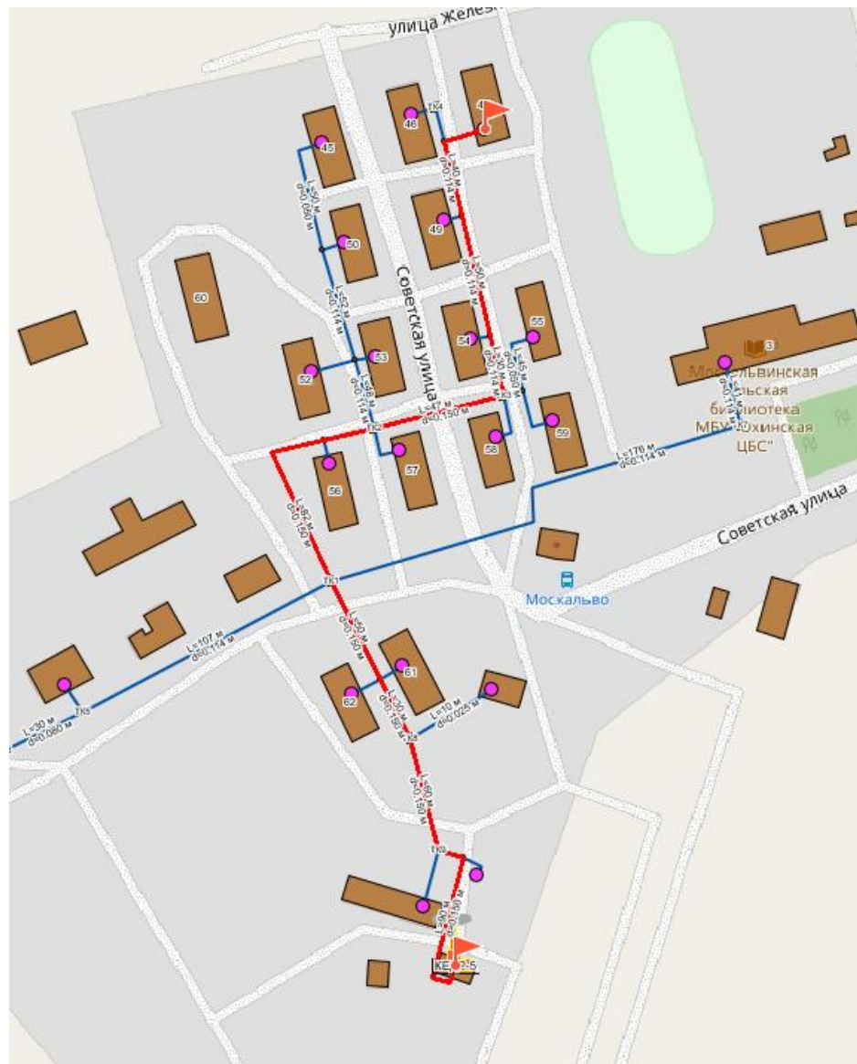
Рисунок 41 - Путь построения пьезометрического графика от Котельной КЕДР-5 (п. Москальво) до определяющего потребителя – жилой дом (п. Москальво, ул. Советская 47)
