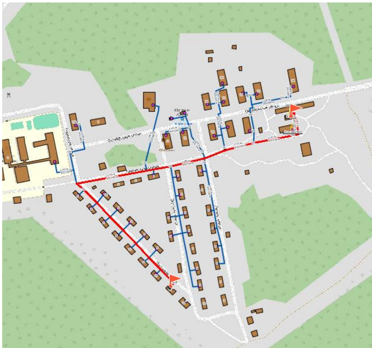
Рисунок 43 - Путь построения пьезометрического графика от БМК-32 (с. Некрасовка) до определяющего потребителя – жилой дом (с. Некрасовка, ул. Парковая 13)
