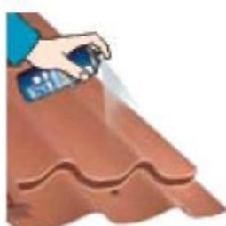
Места срезов, сколов и повреждений защитного слоя, во избежание возникновения коррозии, необходимо обработать ремонтной эмалью для полимерных покрытий AkzoNobel или MOTIP (см. инструкцию на обратной стороне баллончика).
