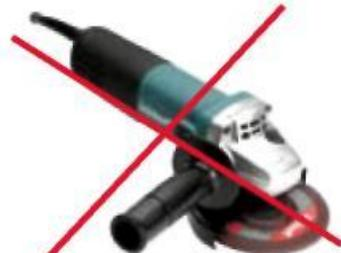
Категорически запрещено использовать углалифовальную машину с абразивным кругом («болгарку»), т.к. выжигается не только полимерное покрытие, но и цинк, в результате чего начинается бурный процесс коррозии.
