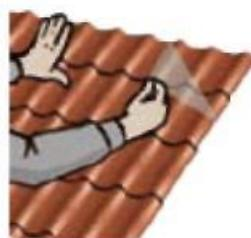
Не допускается эксплуатация изделий с защитной пленкой после монтажа. Пленка снимается в процессе монтажа во избежание ее «прикипания» к полимерному покрытию.
