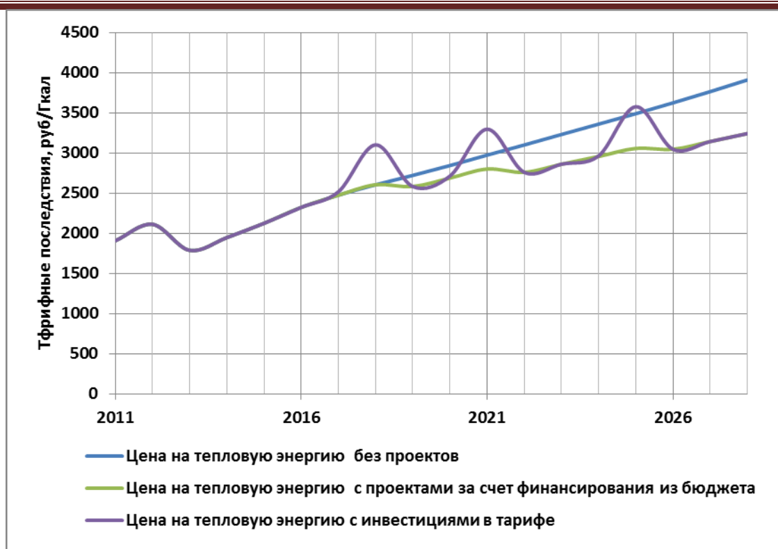
Рисунок 6.3 – Прогноз цен на тепловую энергию при замене существующих котлов котельной № 24 ООО «Городские сети теплоснабжения»
