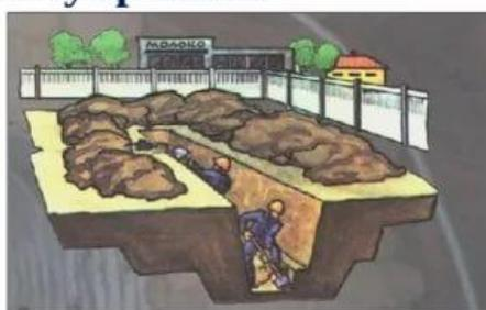
Простейшие укрытия, типа щели, траншеи (открытой и перекрытой), окопа, блиндажа, землянки, подвала, прошли большой исторический путь, но мало чем изменились по существу. Все эти сооружения максимально просты, возводятся с минимальными затратами времени и материалов.
