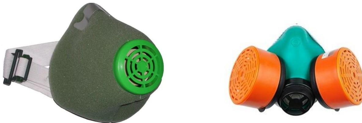
**Респиратор РУ-60М** (рис. 9) состоит из резиновой полумаски, двух сменных фильтрующих патронов, содержащих специализированный поглотитель, пластмассовых манжет с клапаном вдоха, клапанами выдоха с предохранительным экраном, оголовья. Сменные фильтрующие патроны поставляются в комплекте респиратора, но могут поставляться и отдельно. Предназначен для защиты органов дыхания человека одновременно от паро- и газообразных вредных веществ и аэрозолей.
